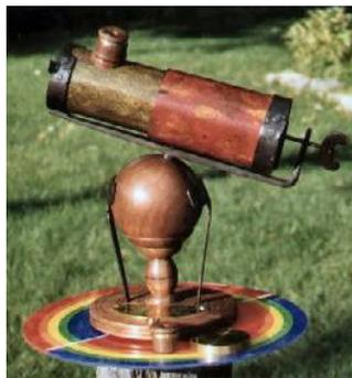
Réplique exacte du télescope 75mm F/d 4,5 d'Isaac Newton<sup>2</sup>
