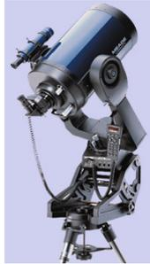
Schmidt-Cassegrain, fixé sur une monture altazimutale à fourche, équipé d'une cale équatoriale<sup>1</sup>
