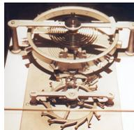
Horloge à ressort spiral réglant accouplé à un balancier annulaire à échappement à ancre<sup>8</sup>
