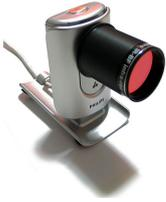
Ci-contre : la ToUcam Pro II, équipée de l'adaptateur Loudèche en aluminium anodisé noir et du filtre IR-Blocking, prête à être fixée au foyer du télescope.
